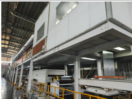
覆膜及涂布工序整室负压收集
